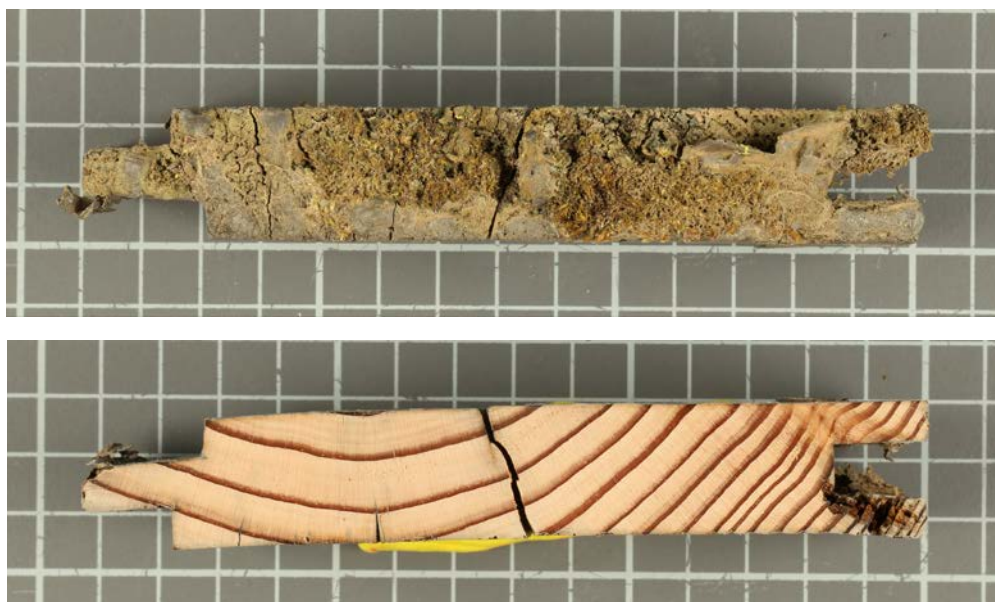
Slika 34 a) i b): Odrezak čela krovne daske debljine ca 2,5 cm. Gore: prikaz izloženog čelnog ruba, dolje: površina na 2,5 cm od čela.
