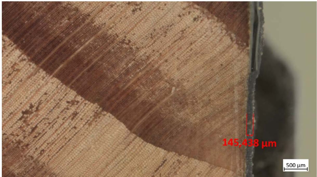
Slika 40. Na poluradijalnoj teksturi drva se ponegdje vidi debeo sloj premaza koji je mjestimično kompaktan, a mjestimično raslojen među nanosima, izvjesno zbog izostanka međubrušenja između nanosa završnih slojeva.
