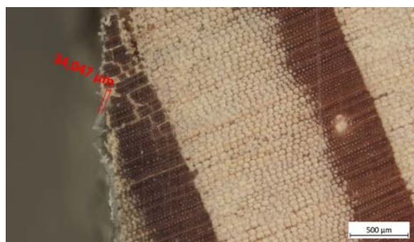
Slika 39 a) i b). Lijevo: ponegdje je adhezija filma dobra, iako je površinski sloj drva iskrzan, vjerojatno pjeskarenjem umjesto brušenja, ili pak erozijom prije obnavljanja. Debljina filma preko 100 µm je dovoljna za vanjske uvjete. Kakogod, na desnoj mikrografiji se vidi vrlo tanki sloj pokrivnog premaza od samo 34 µm.
