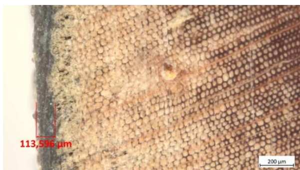
Slika 39 a) i b). Lijevo: ponegdje je adhezija filma dobra, iako je površinski sloj drva iskrzan, vjerojatno pjeskarenjem umjesto brušenja, ili pak erozijom prije obnavljanja. Debljina filma preko 100 µm je dovoljna za vanjske uvjete. Kakogod, na desnoj mikrografiji se vidi vrlo tanki sloj pokrivnog premaza od samo 34 µm.
