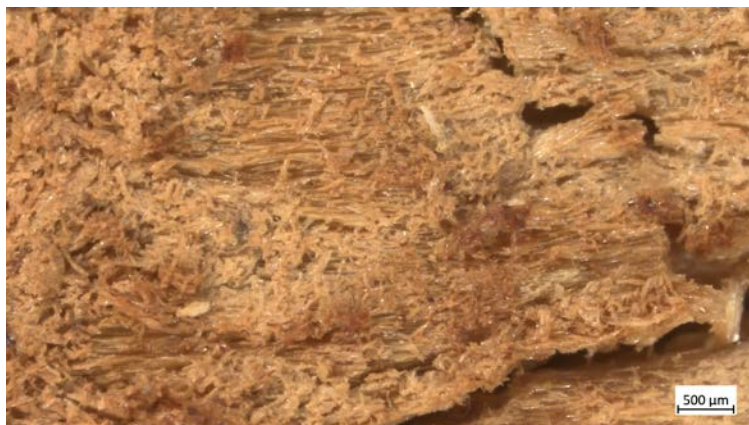
Slika 32. Uzorak izuzet iz trulog dijela radijalne gredice konstrukcije terase (detalj sa slike 31.), potpuno propao od bijele truleži. Mikrografija (lijevo) pokazuje zaostali sloj celulozних vlaknaca koji zaostaje nakon razgradnje lignina.
