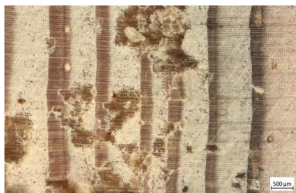
Slika 33 a) i b). Lijevo: makrografija izreska iz površinski jako oštećene gredice. Jasno je vidljiva granica uklopljene bjeljike (svjetliji sloj gore lijevo) od srževine ariša. Na površini je bjeljika potpuno rastočena. Desno: mikrografija pokazuje da je i naoko kompaktan dio bjeljike perforiran enzimatskom razgradnjom gljiva truležnica.
