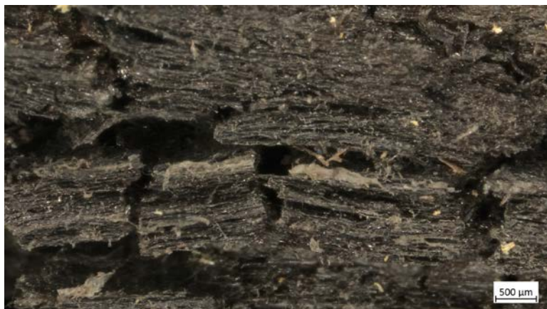
Slika 29 a) i b). Dio stupića ograde potpuno propao od truleži. Mikroskopski (lijevo) se determinira smeđa trulež s karakterističnim kockastim poprečnim pucanjem, koja izjeda predominantno celulozu, a zaostaje amorfni sloj lignina.
