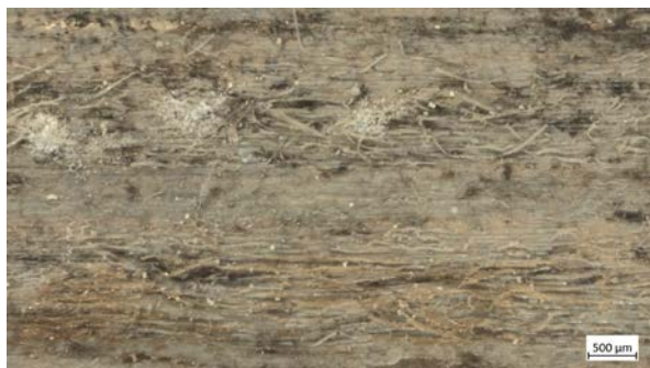
Slika 38 a) i b). Mikroskopski izgled naličja oljuštenog filma premaza. Na sivom sloju boje se vidi sloj iskrzanih i oslabljenih vlaknaca drva, posljedicom loše predpripreme drva prije površinske obrade, dočim se na dijelu filma vidi žuti amorfni sloj bez zaostalih vlaknaca drva.
