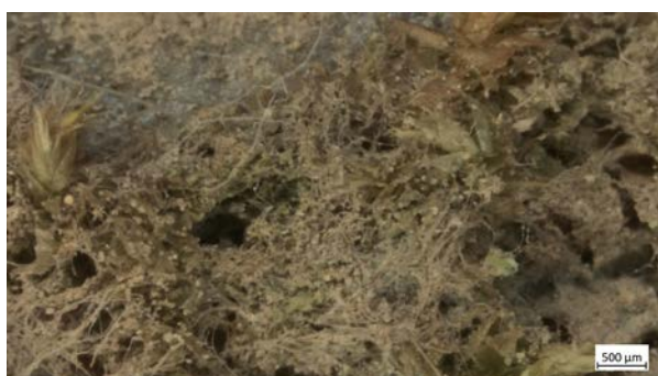
Slika 36 a) i b). Mikrografije uzorka sa slike 32. Na čelu je drvo potpuno rastočeno (lijevo), ali je samo 2,5 cm od kraja drvo zdravo. Biološka razgradnja je ovdje ograničena samo na čelnu zonu učinkovitim prosušivanjem.
