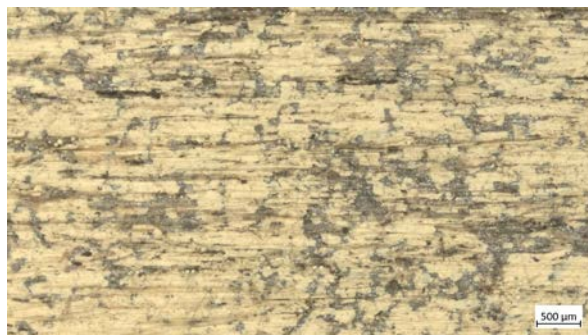
Slika 38 a) i b). Mikroskopski izgled naličja oljuštenog filma premaza. Na sivom sloju boje se vidi sloj iskrzanih i oslabljenih vlaknaca drva, posljedicom loše predpripreme drva prije površinske obrade, dočim se na dijelu filma vidi žuti amorfni sloj bez zaostalih vlaknaca drva.
